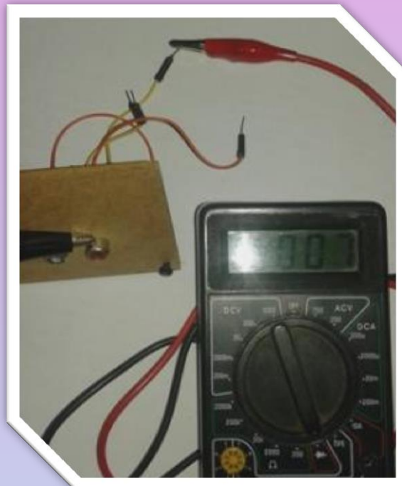
Figura- 14- Teste do RCA fêmea e os jumpers.
