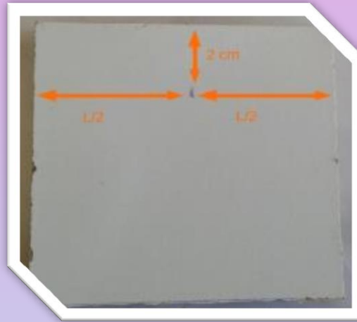
Figura- 20- Medindo as dimensões da tampa para encontrar o centro.
