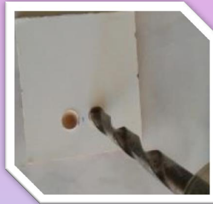
Figura- 22- Realizando os furos na tampa.
