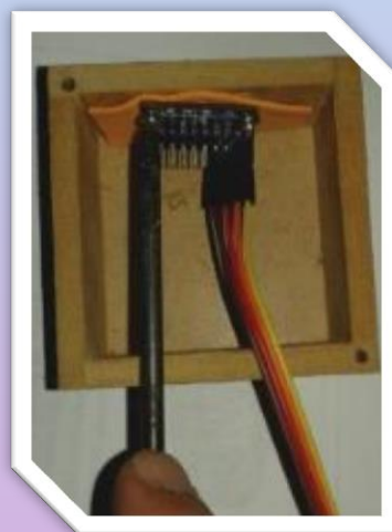
Figura- 19- Sensor sendo fixado na caixa de MDF.
